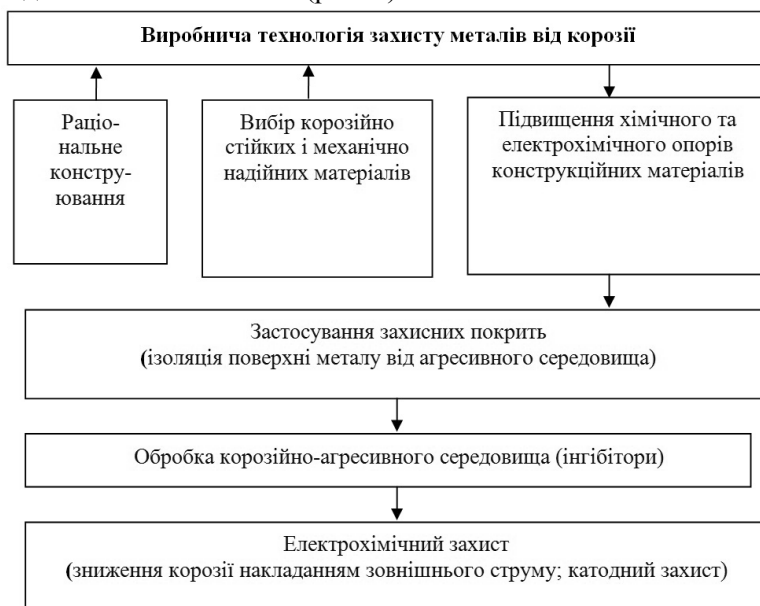
Рис. 2. Етапи виробничої інформаційної технології для захисту металів поліграфічного матеріалознавства від корозії
