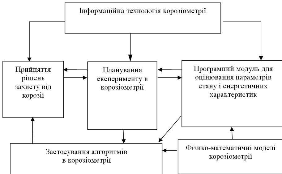
Рис. 1. Структурна схема концептуальної моделі інформаційної технології для визначення енергетичних характеристик поверхневих шарів металів
