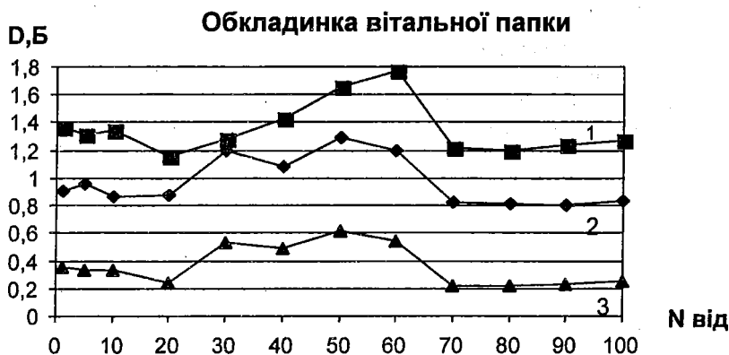
Рис. 2. Залежність оптичної щільності жовтої фарби від порядкового номера відбитка:
