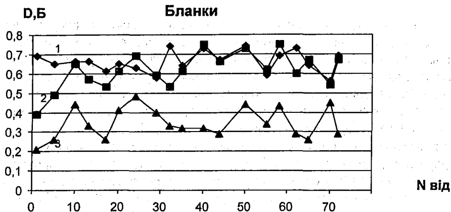
Рис. 3. Залежність оптичної щільності жовтої фарби від порядкового номера відбитка: 1 – відносна площа растрових елементів на фотоформі 100%; 2 – відносна площа растрових елементів на фотоформі 80%; 3 – відносна площа растрових елементів на фотоформі 40%
