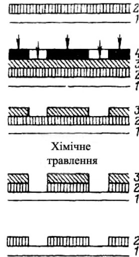
Рис. 4. Четвертий технологічний варіант виготовлення офсетних друкарських форм на формній пластині: 1 — лавсан; 2 — нікель-фосфор; 3 — копіювальний шар; 4 — негатив
