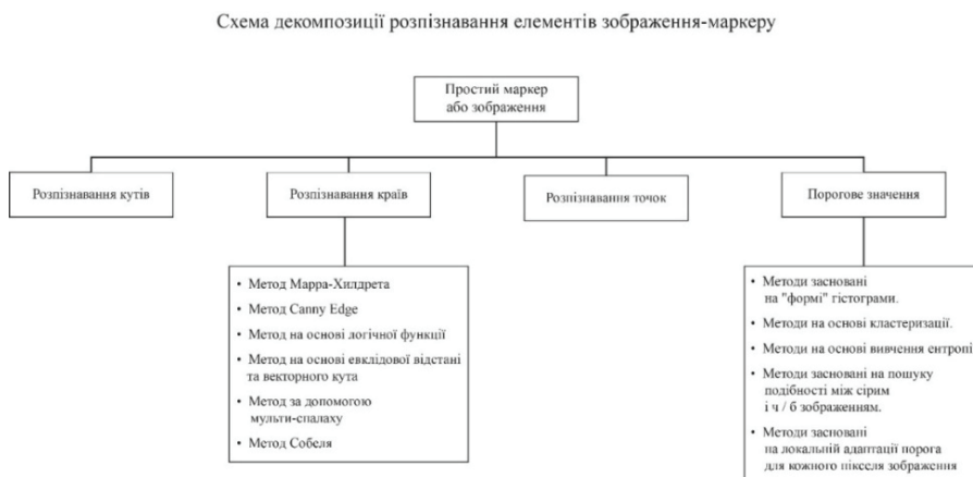
Рис. 5. Схема декомпозиції процесу розпізнавання маркера
