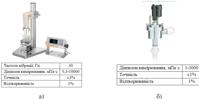
Рис. 6. Вібраційний віскозиметр: а) SV-100; б) Brookfield AST-100
