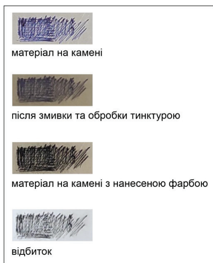
Рис. 3. Етапи відтворення зображення на формі та відбитку з використанням ручки кулькової «Round Stic M», виробництва «BIC»
