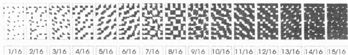
Рис. 7. Градаційна шкала, побудована за методом заповнення фрактальної кривої Гільберта
