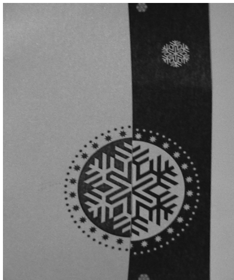
Рис. 1. Сфальцована поштівка (права сторона — після першого разу проходження через пічку, ліва — після другого)
