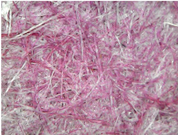
Рис. 3. Вигляд волокон у композиційному складі картону зразків № 1, 3 і 4
