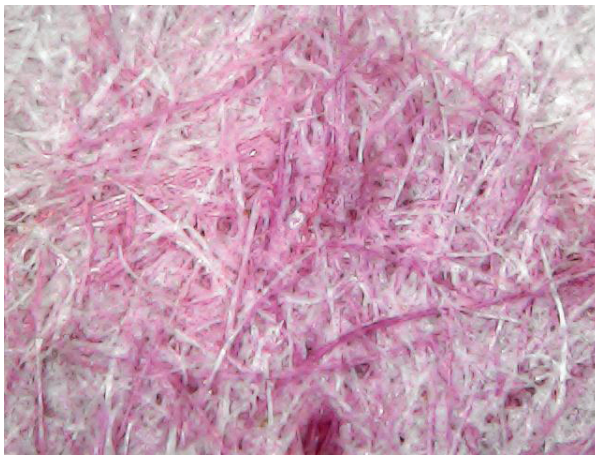
Рис. 4. Вигляд волокон у композиційному складі картону зразків № 2
