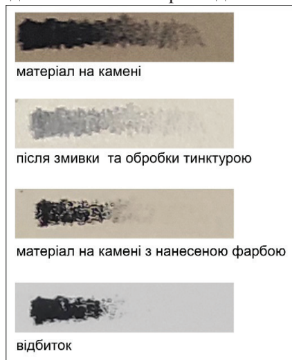
Рис. 8. Етапи відтворення зображення на формі та відбитку з використанням олівця-склографа чорного, марки «KOH-I-NOOR»
