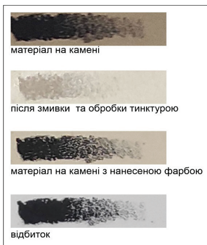
Рис. 6. Етапи відтворення зображення на формі та відбитку з використанням олівця-склографа чорного, марки «Faber-Castell»
