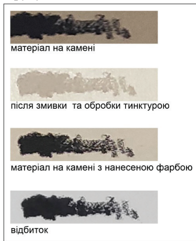
Рис. 4. Етапи відтворення зображення на формі та відбитку з використанням олівця для брів чорного, марки «LCF» Eye Brow
