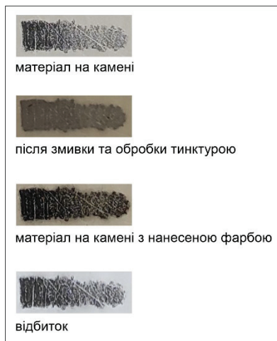
Рис. 1. Етапи відтворення зображення на формі та відбитку з використанням олівця для скла чорний «Hardy»
