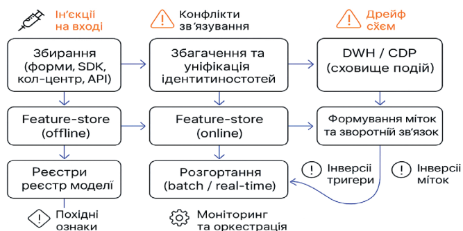
Рис. 1. Узагальнена схема CRM-конвеєра з позначеними поверхнями атаки
